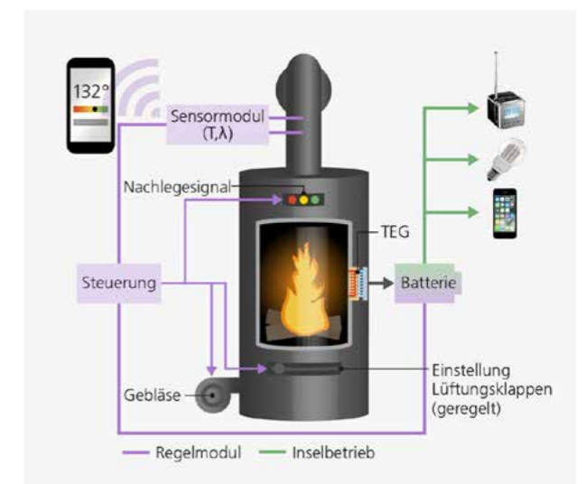
Ein thermoelektrischer Hochtemperatur-Generator, eingebaut in eine Kleinfeuerungsanlage, kann den notwendigen Strom bereitstellen, um kleine Regelmodule zu betreiben, die z. B. den optimalen Zeitpunkt zum Holznachlegen signalisieren oder die Luftzufuhr optimieren.
