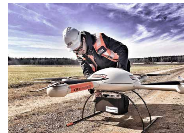
Bereit zum Abflug: Ein STRABAG-Mitarbeiter bereitet den Start der Drohne vor. Die aufgenommenen Daten werden später automatisch ausgewertet.
