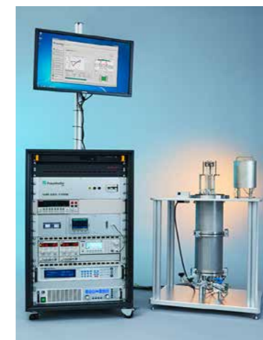
Das Messsystem SRX-vdP kombiniert verschiedene Messmethoden, die zuvor bereits einzeln in kommerziellen Labormessgeräten zur Materialcharakterisierung eingesetzt wurden.
